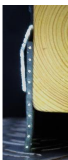
Enkelskiktsinstallation med 35 mm bred lag lista
